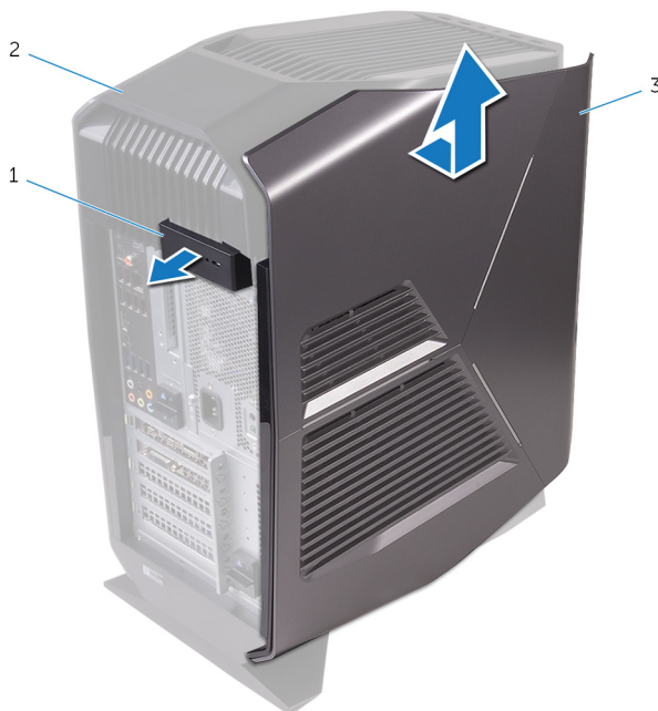
Skica 2. Odstranjevanje levega pokrova
